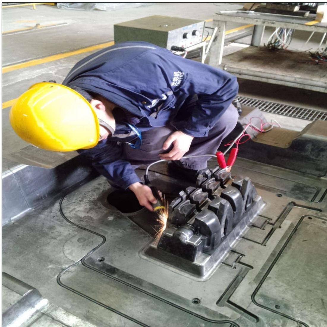
试验目的在于是否可以减轻**热裂纹**及温度疲劳。本次试验非常成功，这副模具被抢救过来了并且运行的大约 35000 次后还可以继续使用，这副模具可以再次进行表面放电沉积硬质合金材料而延长模具的使用寿命。在一个新的模具表面预先进行放电沉积处理可以有效地减少热裂纹产生的几率，热裂纹超出限定的尺寸之前在模具表面进行钨基硬质合金放电沉积处理可以延长模具的使用寿命而中间不需要维护。
