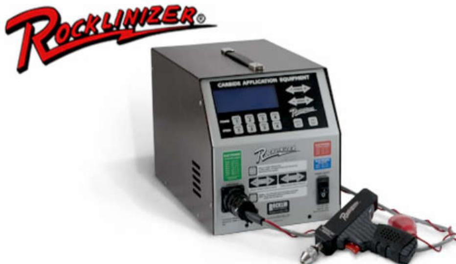
美国 ROCKLIN 公司的金属表面镀硬机 850E 是应用放电镀层技术使电极材料在金属表面形成一层局部耐磨超硬镀层。其特点是涂镀过程不产生可感热度，因此也不产生因热造成的各种缺陷；镀上的耐磨材料也不会脱离或剥落，涂镀过的表面无需再进行热处理便可达到足够的硬度，如需要还可进行精磨等其它表面加工。
